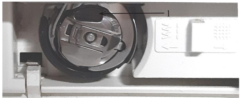
Spulenkapsel mit der Spule voran, die große Öffnung nach oben in den Greifer einsetzen. Mit dem Daumen nachdrücken. Es muß klicken, sonst besteht die Gefahr, dass die Spulenkapsel nicht richtig im Greifer sitzt und beim Nähen herausfällt.
