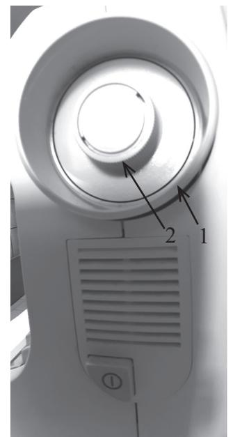
Durch gleichmässigen Druck, mit dem Fuß auf den Fußanlasser, das Garn auf die Spule spulen.
